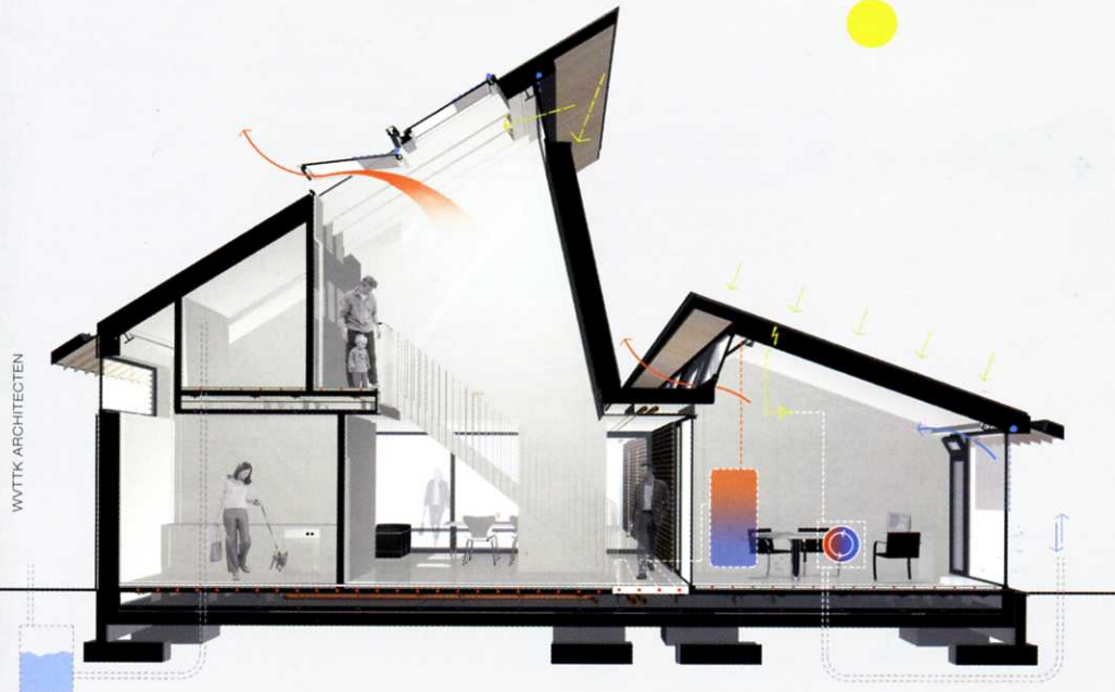
Energetische doorsnede en impressie van het atrium
